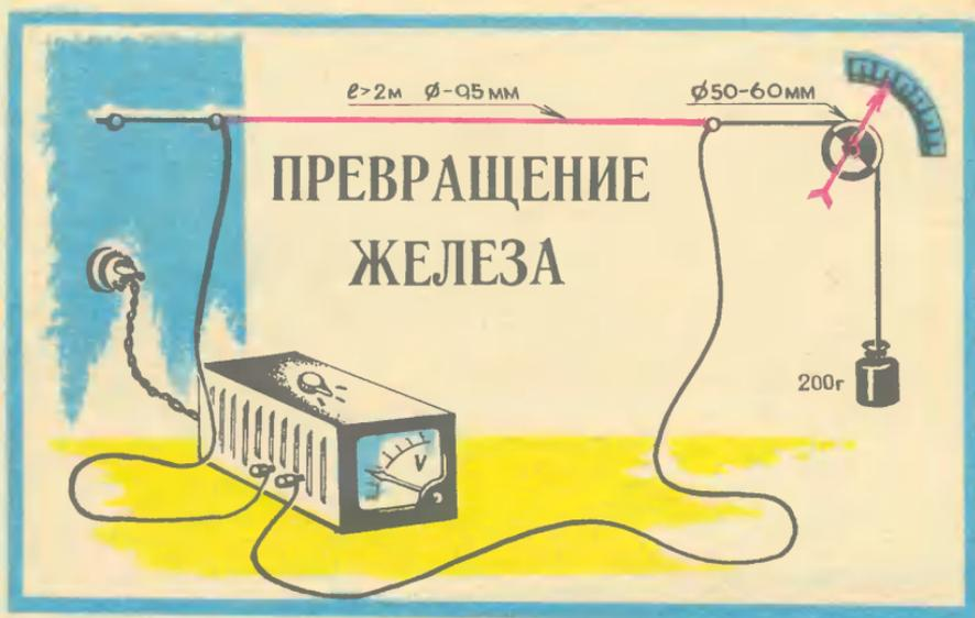
Один конец тонкой стальной проволоки закрепили, а второй перекинули через блок и подвесили на него грузик. Проволока натянута. К ней подсоединили провода и включили ток. Прошло несколько секунд, и проволока нагрелась, засветилась все ярче и ярче. Ну и, конечно, нагревшись, она стала удлиняться, грузик пополз вниз. Но вдруг остановился и, хотя проволока продолжала нагреваться, сканнул вверх. Что случилось? Разве всем известный закон, что металлы
